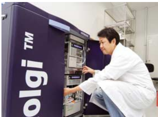
人工ゴルジ装置による複合糖質の自動合成法「糖質自動合成装置Golgi™」。世界の医薬開発研究のフロントラインで利用される革新的技術として製薬会社などから高い評価を受けており、次世代糖タンパク質製剤市場創出への展開が期待されている
