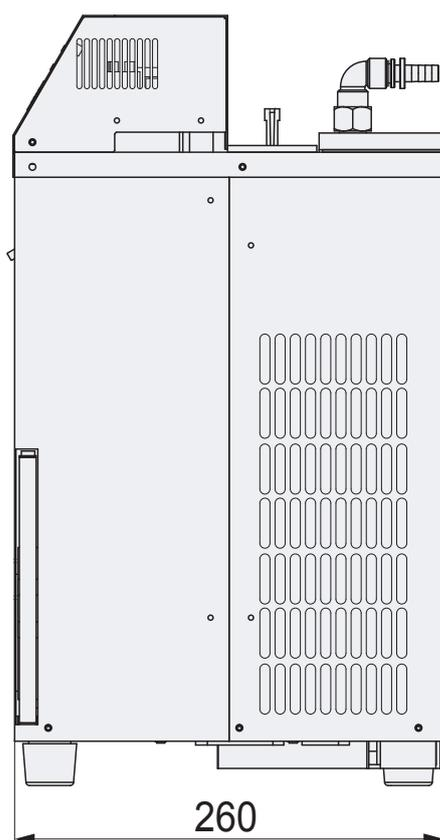
冷却水接続口径:ワンタッチコネクタ・ホースノズル 内径10mm・外径10mm
