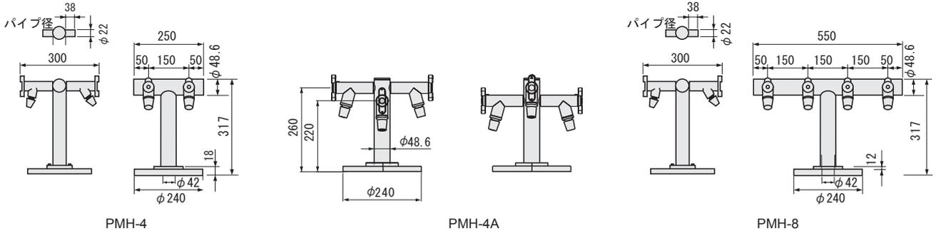
試験管・アンプル瓶用多岐管
